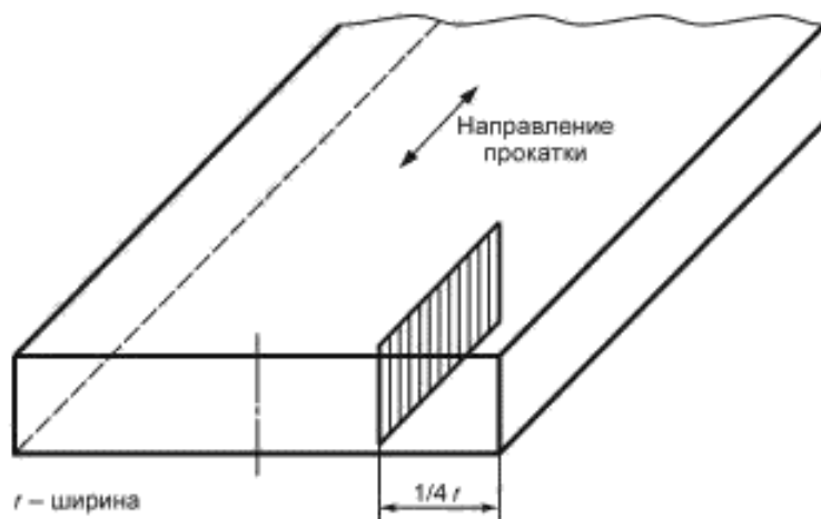
Рисунок 4 — Образец от листа толщиной не более 25 мм
