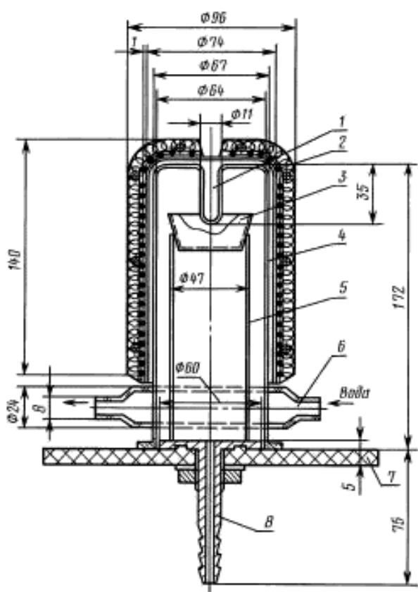
1 — ввод для термометра; 2 — нагреватель мощностью 500 Вт; 3 — чашка с пробой; 4 — кварцевая вакуумная камера; 5 — подставка; 6 — кессон; 7 — прокладка из вакуумной резины; 8 — вакуум-штуцер
