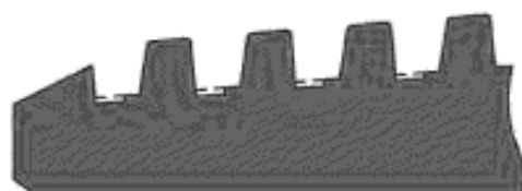
г) Подрез впадины витка резьбы
