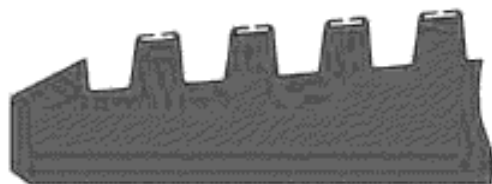
в) Подрез вершины витка резьбы
