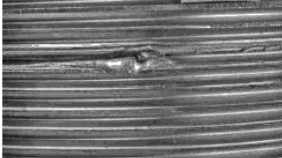
а) Рванина на витке наружной резьбы
