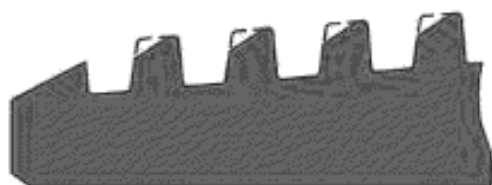
д) Подрез вершины витка резьбы
