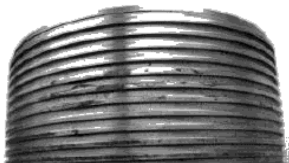
а) Следы коррозии на наружной резьбе
